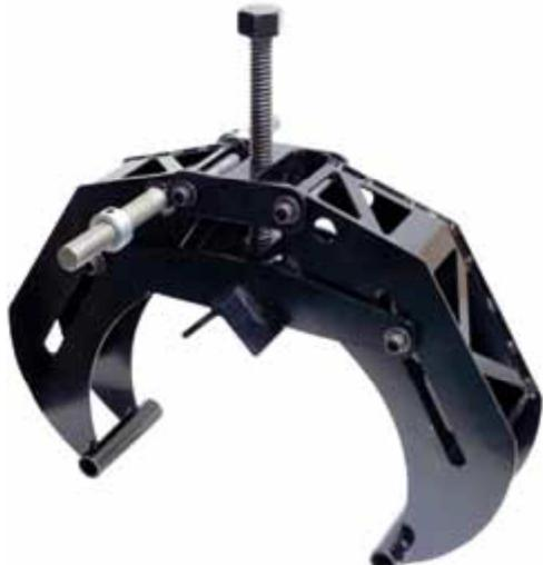
Трубный зажим для гидравлической пилы ICS 890 PowerGrit разработан для того, чтобы взять на себя вес пилы от оператора, сделать пилу более устойчивой и получить более прямолинейные и точные распилы, тем самым увеличить ресурс цепи. Хомут применяется с трубами диаметром от 10 до 30 см в зависимости от того, какая используется пила и направляющая шина.
